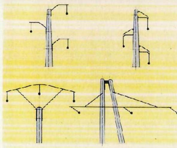
**Figure 4 : Réseau électrique HTA nu - Technique suspendue**
