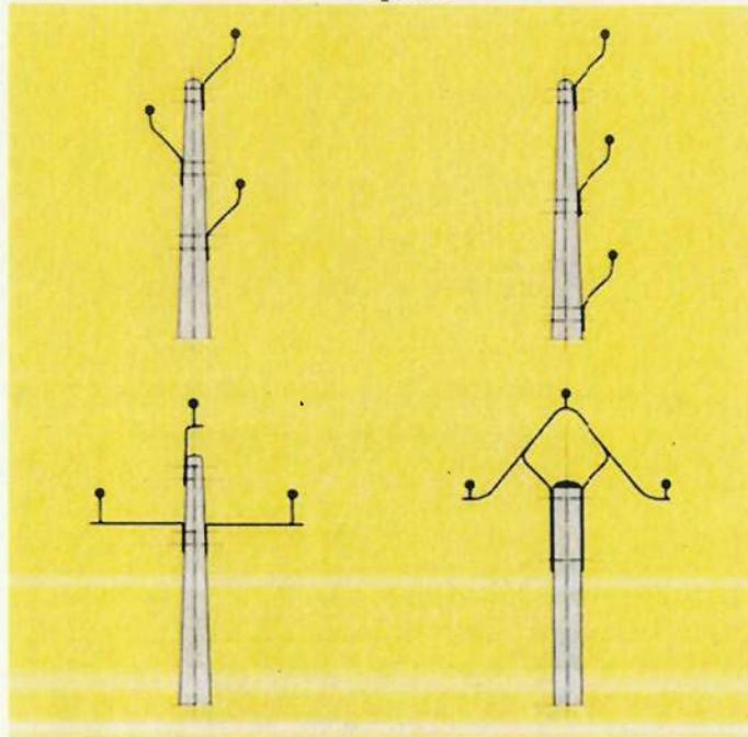
**Figure 3 : Réseau électrique HTA - Technique rigide**
